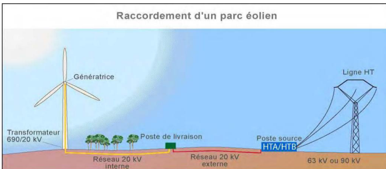
Organisation générale du raccordement électrique au réseau de distribution (Source : Etude d'impact - ENCIS Environnement, décembre 2024)
